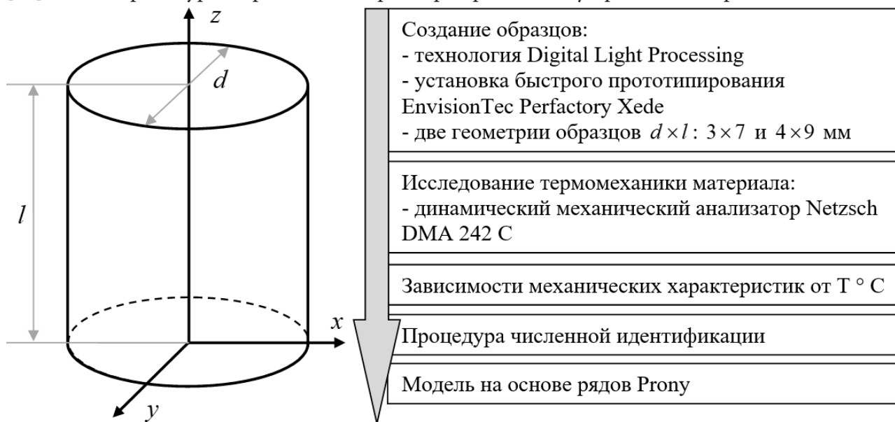
Рис. 1. Схема определения термомеханической модели поведения материала
