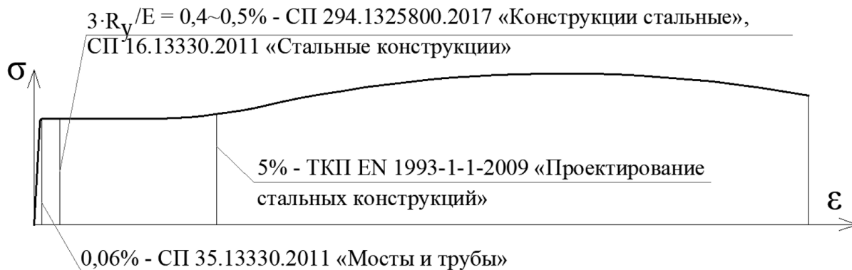
Рис. 1. Диаграмма растяжения стали 15XCHD
